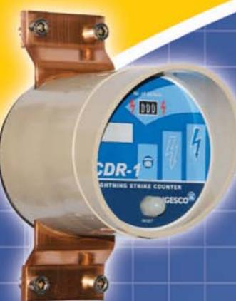
یکی از موثرترین و ساده‌ترین روشها جهت اطلاع از وقوع صاعقه، استفاده از شمارنده اصابت صاعقه است. ۱- یک شمارنده الکترومکانیکی است که بدون نیاز به منبع توان خارجی می‌تواند تنها از انرژی موجود در جریان صاعقه بوره بردار را از وقوع صاعقه آگاه سازد. این شمارنده به صورت موازی بر روی هادی میانی نصب و از طریق القاء الکترومغناطیسی قادر است عبور جریان صاعقه را شناسایی می‌کند. به ازاء هر اصابت و عبور جریان یک شمارش انجام می‌شود.
